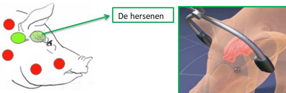
Links: Afbeelding Haluk Anil. Groen= goede positie elektroden. Rood = slechte positie elektroden. Rechts: OIE – correcte positie van de elektroden.
