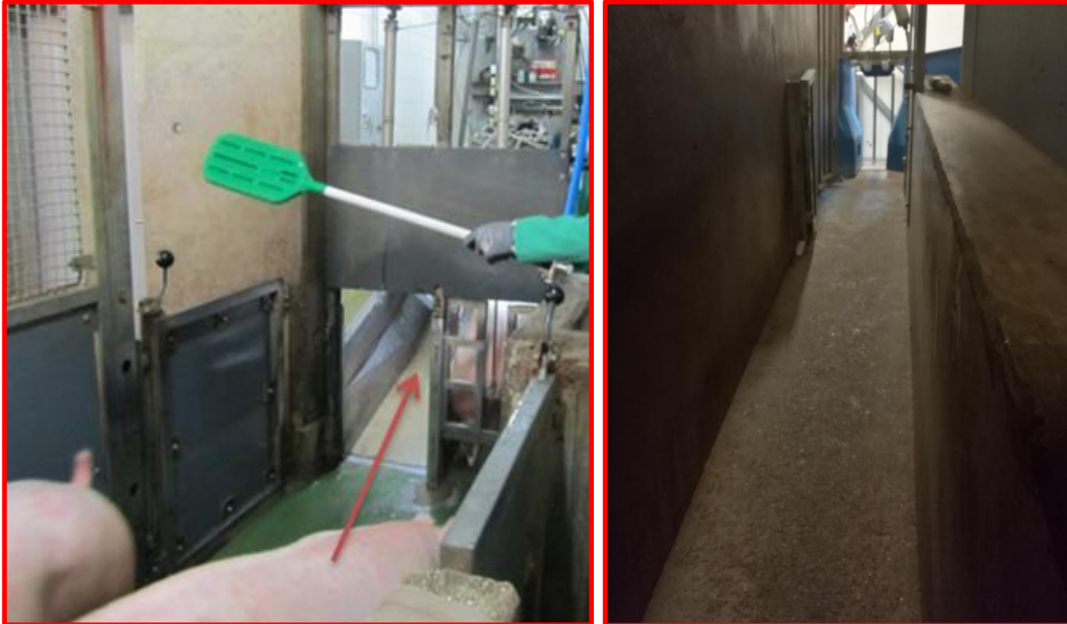
Een individuele drijfgang met een helling bemoeilijkt het opdrijven naar de verdoover
