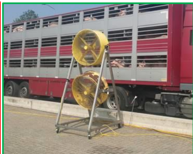
Links, oude situatie: ventilatoren staan te laag en bereiken niet alle laadniveaus. Rechts, nieuwe situatie; hoge verstelbare ventilatoren om alle laadniveaus voorin de truck te bereiken.
