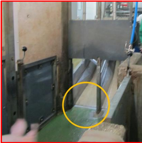
De overgang naar een andere kleur of materiaal vloer zorgt voor opstoppingen
