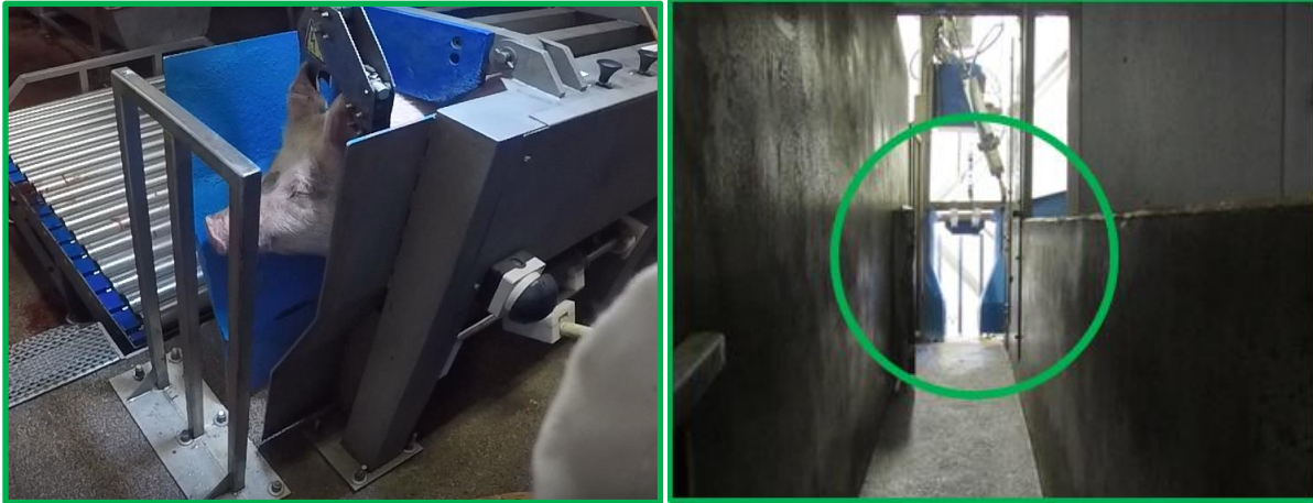
De box in de nieuwe situatie: de voorkant is opengewerkt. Varkens zullen beter doorlopen omdat de drijfgang en box minder doodlopend lijken.
