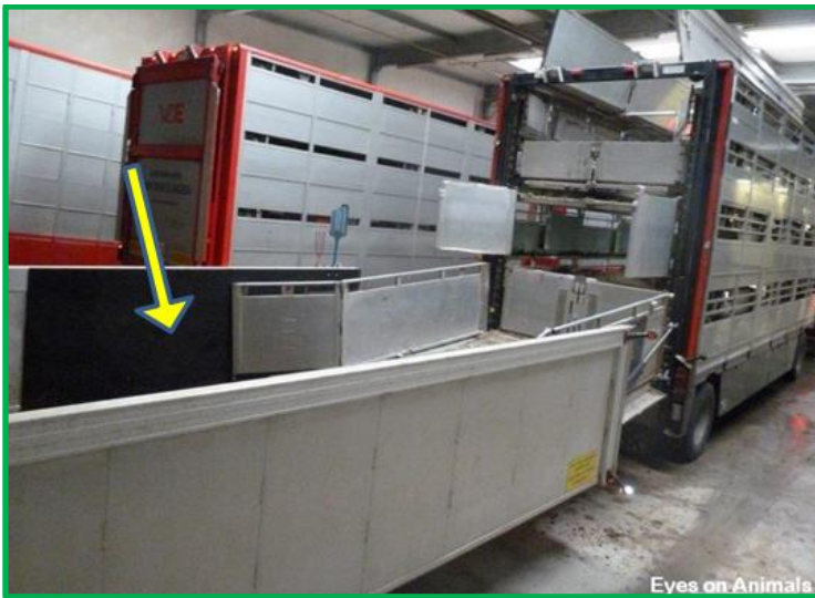
Bevestig rubber materiaal om geluid te dempen bij het lossen
