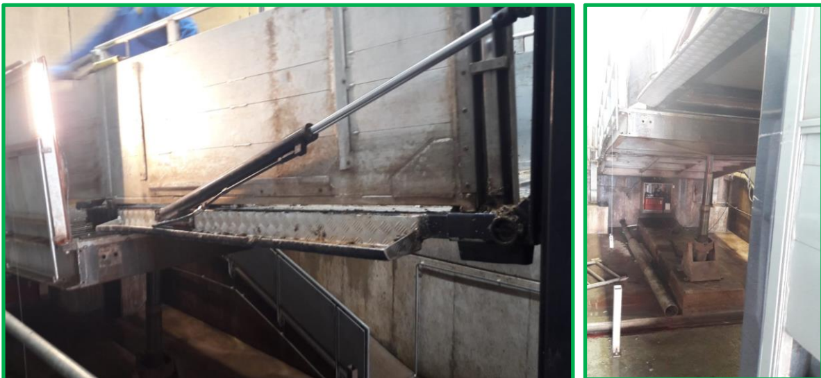
In hoogte verstelbare losbrug zodat er geen of een hele lichte helling is, zorgt ervoor dat varkens beter lopen.
