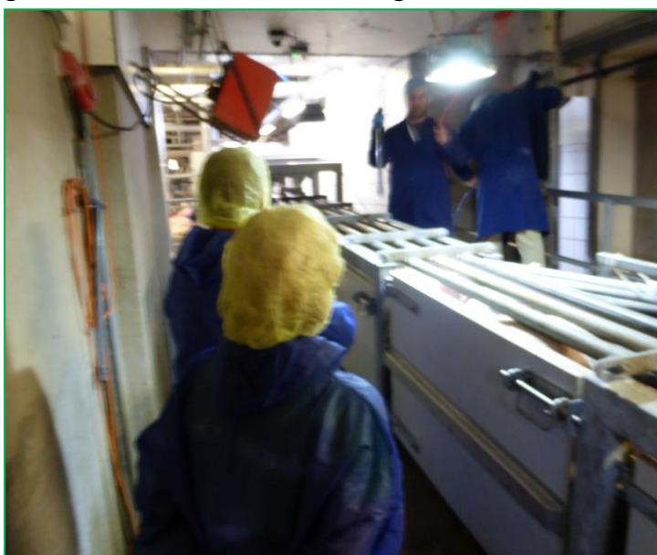
Bij Compaxo zijn extra lampen boven de drijfgang geplaatst. Het resultaat: de varkens zijn minder gestrest en lopen gemakkelijker door.
