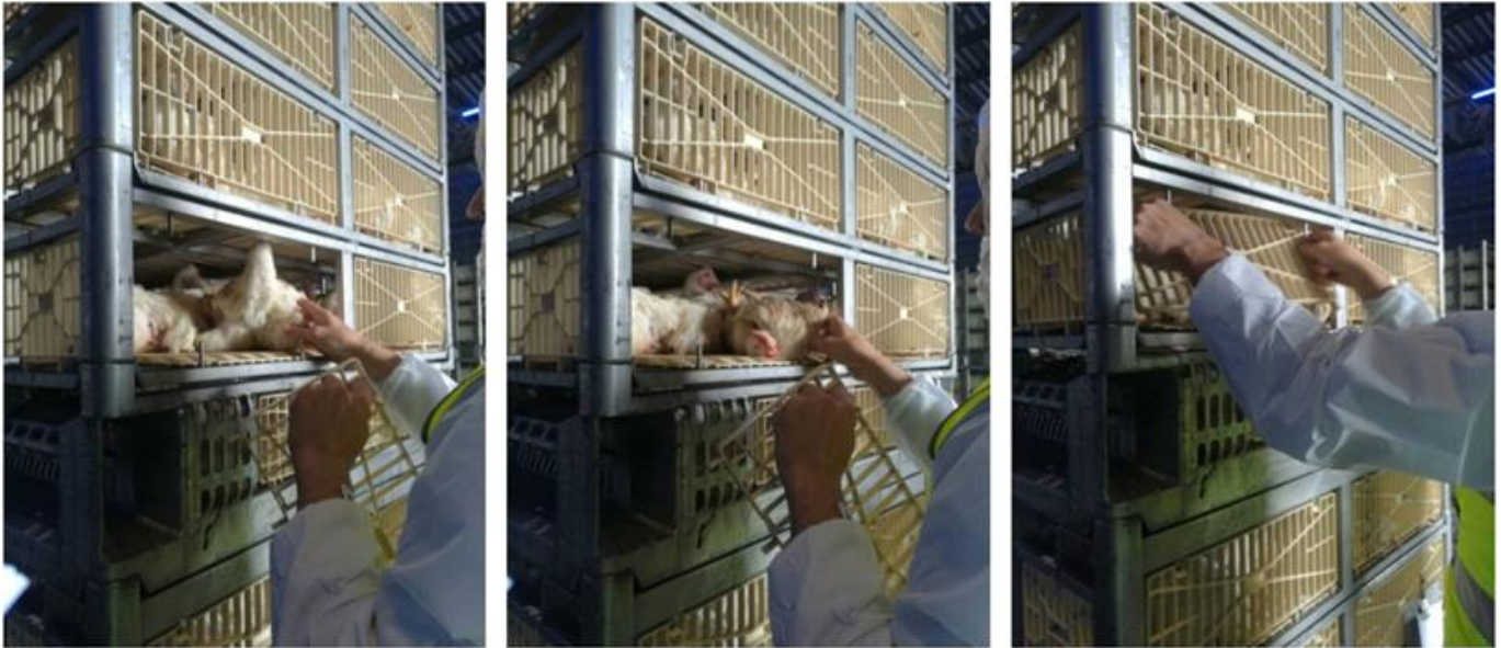
Nieuwste Marel containers met toegangsdeuren waardoor een rugligger rechttop kon worden gezet.
