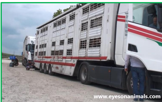
Goed isolerend en lichtkleurig materiaal zorgen dan het binnenin de truck zo koel mogelijk blijft.
