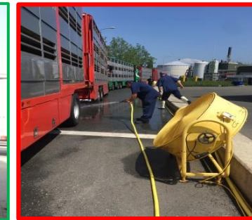
Te kleine en te lage ventilator.
