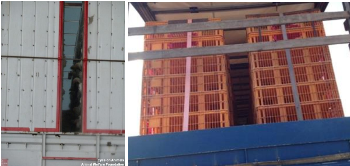
Truck met gang in het midden om luchtcirculatie te verbeteren. Links: pluimveetruck, rechts: konijnentruck. ©Eyes on Animals
